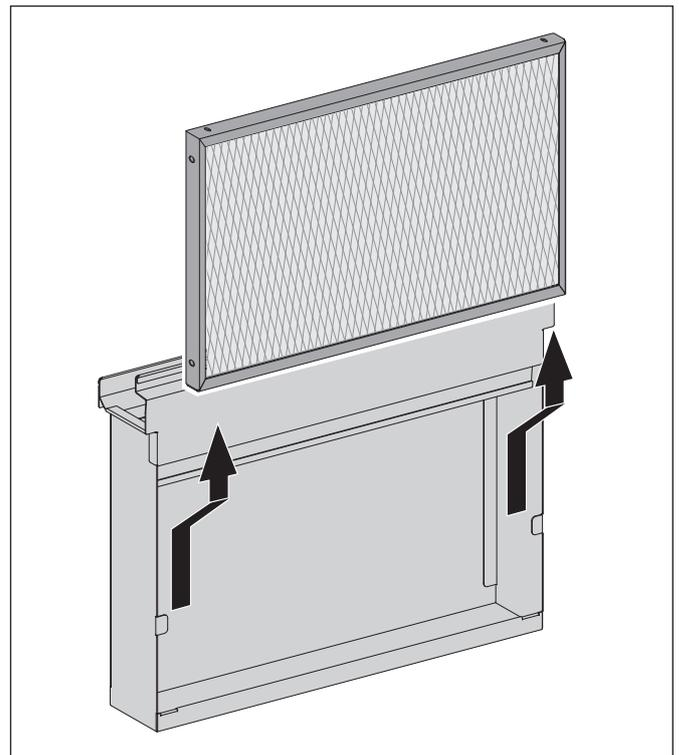
☞ Nehmen Sie den Fettfilter aus dem Filterkasten.
