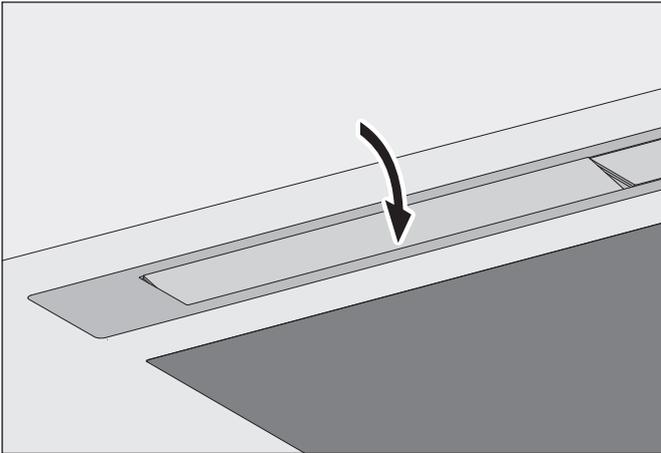
☞ Um die Klappen zu öffnen, drücken Sie die Klappen nach innen.
