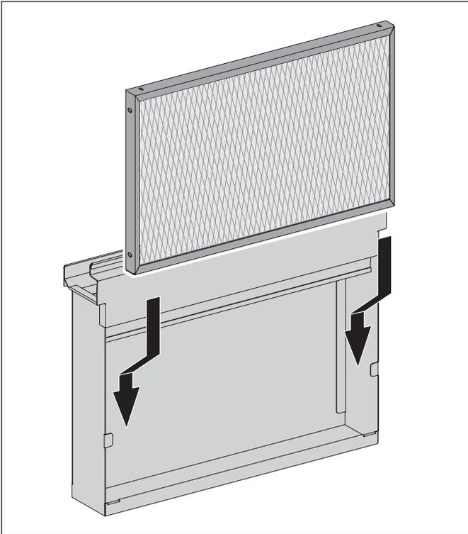
☞ Setzen Sie den Fettfilter in den Filterkasten.
