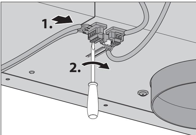
Der Anschluss erfolgt über Kabelklemmen am Lüftergehäuse. Die Kabelklemmen sind beschriftet:
