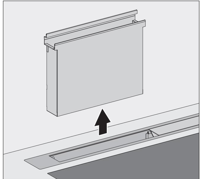
☞ Ziehen Sie den Filterkasten nach oben heraus.
