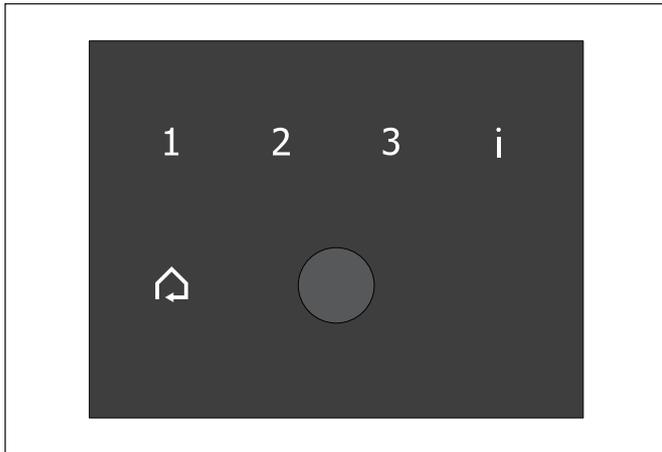
Die Position des Bedienfelds ist an der Mulde der EIN/AUS-Taste jederzeit zu erkennen. Die übrigen Tastfelder leuchten, wenn das Gerät eingeschaltet ist.
