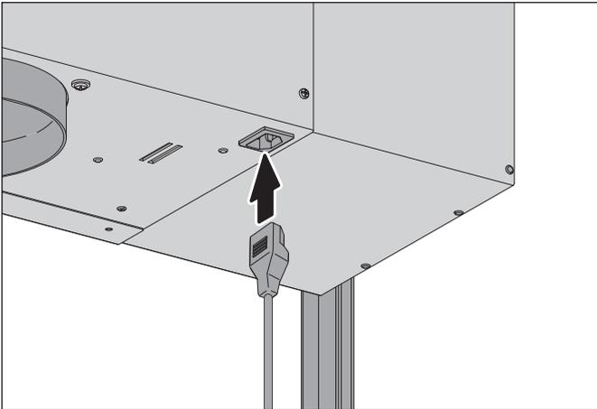
☞ Stecken Sie den Kaltgerätestecker in die Anschlussbuchse am Lüftergehäuse.
