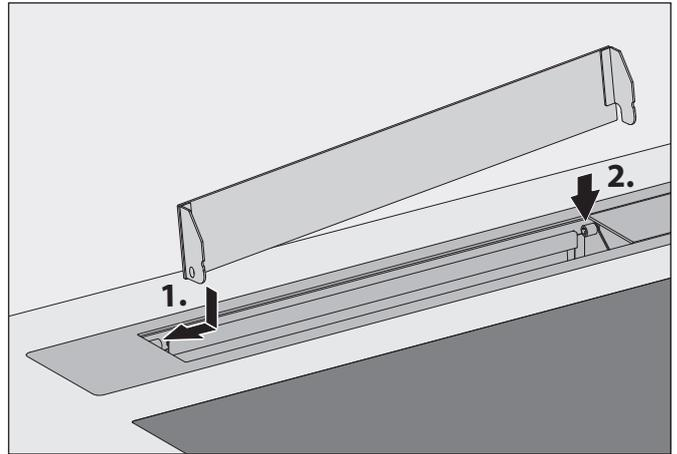
☞ Setzen Sie die Lüftungsklappe wieder ein.
