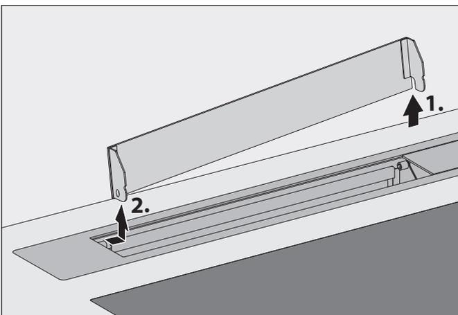
☞ Ziehen Sie die Lüftungsklappe nach oben heraus.
