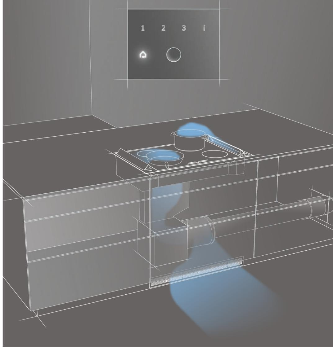
Der Abluftbetrieb führt die von Fetten gereinigte Luft nach außen. Besonders effizient ist diese Betriebsart bei intensivem Anbraten. ▼
